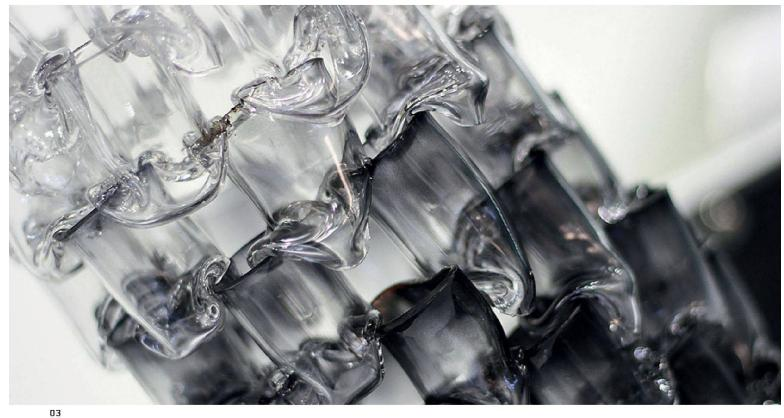
03-04 Beim Projekt «Hot Networks» fügten Roboter Plastikröhren zusammen und bearbeiteten sie mit einer Heissluftpistole. 05 Screenshot: Die eigens entwickelte Software stellt die Bewegungen der verschiedenen Roboterarme dar.
