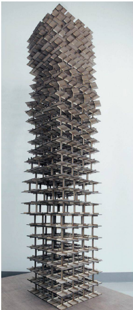
03 Beispiel einer Anwendung: Das Grundmodul des Turms ist repetitiv und wird durch die Logik der Assemblierung zu einer komplexen und differenzierten, räumlichen Struktur. (Foto: Gramazio & Kohler, ETH Zürich)
