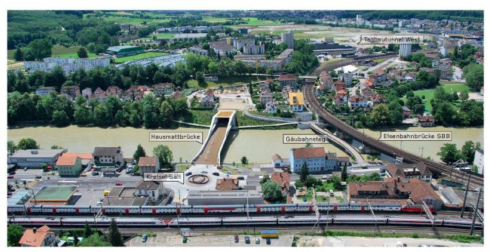
01 Mit dem Kreisel Säli in Olten wird die neue Entlastungsstrasse an die Aarburgerstrasse angebunden. Anschliessend überquert die 15.60 m breite und 88.50 m lange neue Brücke die Aare stützenfrei und mündet direkt in den 390.50 m langen Hausmatttunnel. Die Entlastungsstrasse unterquert im bergmännisch erstellten Tunnel das Wohnquartier Kleinholz und führt dann weiter Richtung westlicher Stadtrand, nach Wangen und Rickenbach. (Foto: Amt für Verkehr und Tiefbau. Kanton Solothurn)
