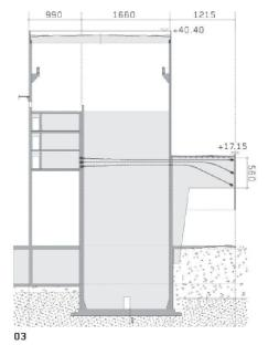
als Waben- und Faltwerk, das die grossen Horizontalkräften aus äusseren Erdlasten und aus den Müllbergen in den Kammern effizient aufnehmen kann. Zugleich bildet das Faltwerk die Verankerung des Dachs, das über dem Verladebereich 12 m auskragt. Dieses Dach besteht aus für eine Rissverteilung vorgespannten Scheiben und einer Betonschürze am Kopfende.
