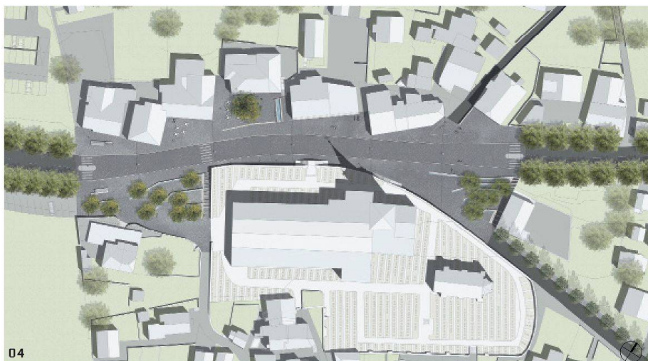
03–04 «Mandelblüte» (ARGE bbz): Die Verfasser schlagen eine grosse zusammenhängende Fussgängerfläche vor. Die vorhandenen Höhenunterschiede werden durch sanfte Angleichung auf ein Minimum reduziert. Ein homogener Asphaltbelag mit unregelmässig eingestreutem Edel Splitt bindet den polyzentralen Platz zusammen. Die Verkehrsführung findet auf einer klar definierten Mittelachse statt, der mit Naturstein begrenzten Kantonsstrasse. Situationsplan, Mst. 1:2000.
