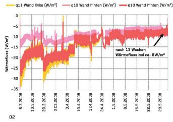
01 Ergebnis aus den Untersuchungen im Testraum: Temperaturverlauf im Mauerwerk nach Beginn des Beheizens
