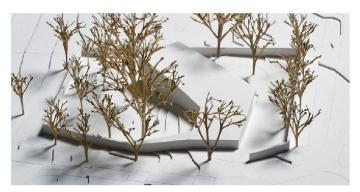
01 Siegerprojekt «Mama Miti»: Das Kanzleigebäude entwickelt sich aus einer Stampfbetonmauer, die das ganze Grundstück umschliesst
