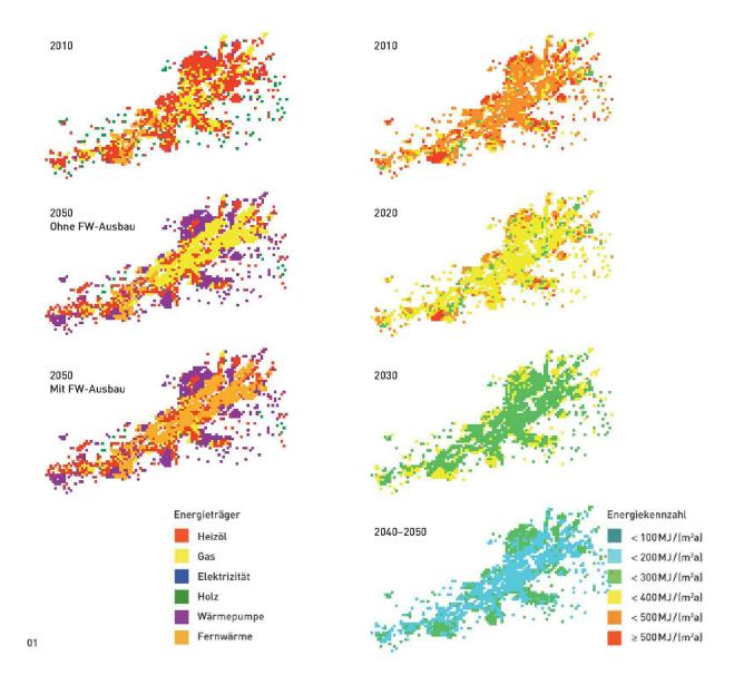
Das Modell ist ein Lagerbestandsmodell, das den zukünftigen Wärmebedarf in Abhängigkeit von der Entwicklung der Energiebezugsflächen und der energetischen Standards der Gebäude berechnet. Die Parameter der Instandsetzungstätigkeit können pro Bau- und Instandsetzungsperiode eingegeben werden. Der CO<sub>2</sub>-Ausstoss hängt im Modell vom Energieträger ab, mit dem die Wärme bereitgestellt wird. Der Energierichtplan der Stadt St. Gallen zeigt, wo ein Wechsel des Energieträgers sinnvoll ist.
