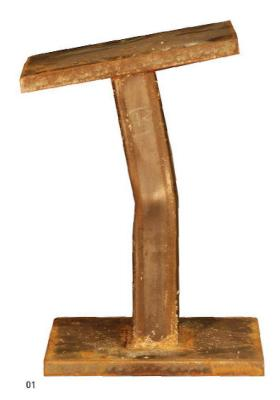
**01** In den experimentellen Versuchen wurden Prüfkörper mit reiner Normalkraft und einachsiger Biegung mit Normalkraft unter Brandlast (normierter Temperaturverlauf) belastet. Hier ein Versuchskörper, nachdem er zentrisch bei 400°C belastet wurde
