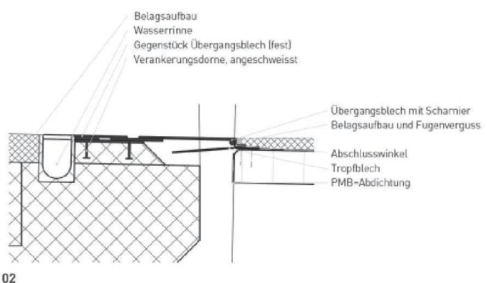
seitlich verschalen und somit vor seitlich eindringendem Wasser schützen. Im Bereich der Fahrbahnübergänge ist unter dem Ausgleichsblech ein weiteres Blech angebracht, das verhindert, dass die Stirnseiten der Träger nass werden. Die Bankette und die Verschalungsteile sind aus Lärchenholz hergestellt und somit einigermaßenwitterungsbeständig. Diese Elemente sind als Verschleissteile konzipiert und können bei Bedarf ausgetauscht werden.
