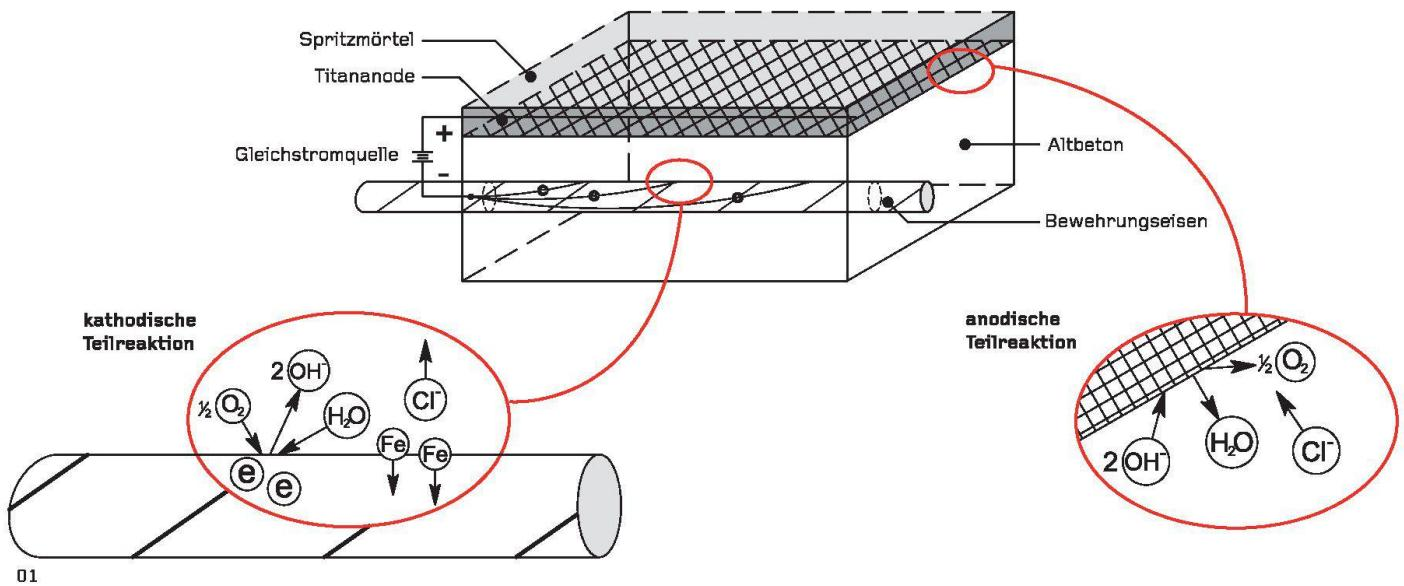
01 Funktionsprinzip des kathodischen Schutzes mit Anodennetz
