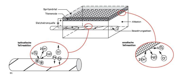
01 Funktionsprinzip des kathodischen Schutzes mit Anodennetz
