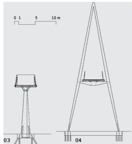
**01–04 «Durchblick» (Ulaga / Nord):** Die beinahe 60m weit gespannte Schrägseilbrücke überbrückt ein Gebäude und die Bahnlinie. Sie ist aus wetterfestem Stahl konstruiert und schliesst an beiden Enden je an eine zwei- resp. eine dreifeldrige Balkenbrücke an. Die sorgfältig gestaltete Oberfläche gibt dem Bauwerk ein einheitliches Aussehen (alle Pläne + Visualisierungen: Projektverfasser)
