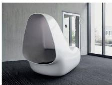
Das Solid-Surface-Material «Hi-Macs» weist eine dichte, homogene und beständige Oberfläche auf. Das Material lässt sich optisch fugenlos verarbeiten. Grosszügige Flächen ohne Kanten erlauben es, dass auch Formteile wie Spülen oder Lavabos hergestellt werden können. Durch Erhitzen kann «Hi-Macs» dreidimensional thermoplastisch verformt werden. Bestimmte Platten (Lucent) zeigen in Kombination mit Licht eine Transluzenz, die sich mit eingearbeiteten Strukturen und Mustern verstärken lässt.
