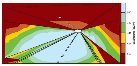
01 Die Lichtberechnung mit LED-Leuchten im Abstand von 8 m zeigt die gleichmässige Ausleuchtung der Tunnelfahrbahn (Grafik: Siteco)
