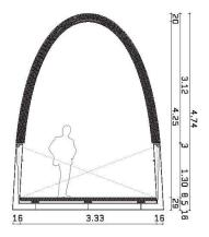
04–06 «Schubert» (DIC SA Ingénieurs): Eine gedeckte, auf Flachfundationen mit Mikropfählen gelagerte Holz-Stahl-Brücke spannt 50 m über die Limmat. Das Tonnengewölbe aus Brettschichtholz ist das Haupttragelement. Den Kanal überspannt eine Rahmenbrücke aus Stahlbeton. Der tunnelartige Raum erlaubt allerdings nur den Blick nach schräg unten auf das Wasser. Ausserdem könnten Kupferionen von der Schindeldeckung in den Fluss gelangen. Längsschnitt, Mst. 1:800; Querschnitt, Mst. 1:100.
