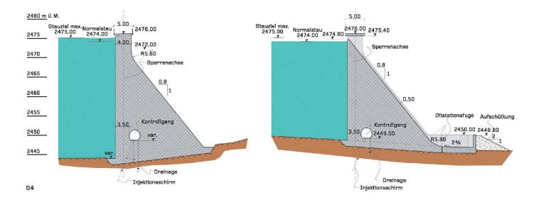
04 Querschnitte der Staumauer Muttsee im Bereich mit der maximalen Höhe (linkes Bild) und im Bereich der Hochwasserentlastung. (rechtes Bild), (Pläne: Axpo)
