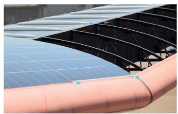
02 Cockpit und Motorgondeln bestehen aus einem speziellen Polyurethanschaum. 03-04 Die Solarzellen sind auf die Rippen der Flügel und des Höhenruders geklebt und bilden deren Oberfläche. Der Flügelholm besteht aus rechteckigen Sandwichplatten aus Kohlefasern und wabenförmigem Kernmaterial aus einer Kartonmischung. An der Flügelunterseite kam Polyestergewebe zum Einsatz. Genauere Details zu Konstruktion und Materialien gibt Solar Impulse nicht bekannt.
