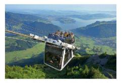
03 Die neue Bahn führt von Kälti auf den Gipfel. Die beiden Gondeln sind durch jeweils eine endlose gespleisste Zug- und Gegenseilschleife miteinander verbunden (Foto: Stanserhornbahn)
