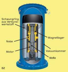
01+02 Das im vergangenen Jahr in Stephentown im US-Bundesstaat New York in Betrieb genommene erste Schwungrad-Speicherkraftwerk. Die insgesamt 200 blauen Behälter enthalten jeweils ein zylinderförmiges Schwungrad von etwa 1.5 m Höhe und 91 cm Durchmesser (Foto und Grafik: Beacon Power)
