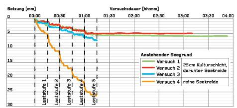
03 Mittels Theodolit aufgezeichnete Setzungskurven bei der Fundstelle Beinwil-Aegelmoos im Hall-wilersee. Die Abbildung zeigt die zeitliche Setzungsentwicklung für vier Lastplattenversuche, die an unterschiedlichen Stellen im Perimeter der Fundstelle durchgeführt wurden. Innerhalb eines Versuchs wurde im Abstand von 15 Minuten die Laststufe und dadurch die Spannung auf den Seeboden erhöht, dies resultierte in zusätzlichen Setzungen (Grafiken 3 und 4: Jochem Seifert/HSR Hochschule Rapperswil)
