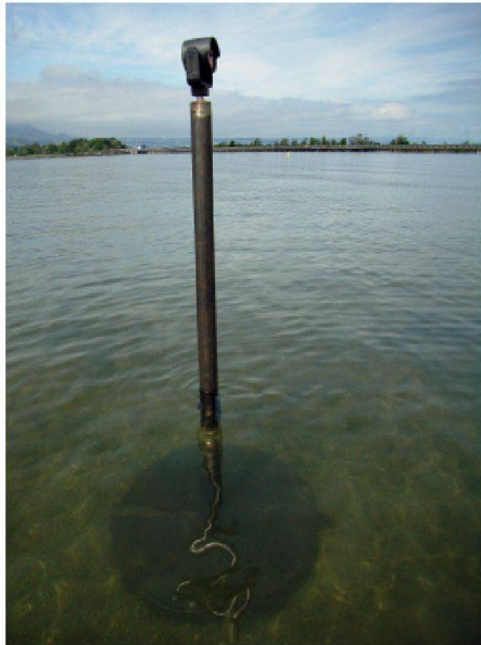
05 Lastplattengerät: Die Grundplatte ist starr mit einer Metallstange verbunden. Am oberen Ende ist ein Prisma aufgesetzt (Foto: Christoph Häfliger, HSR Hochschule Rapperswil)
