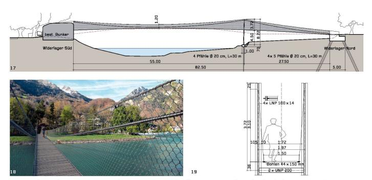
17–19 Aus in der dritten Runde: «Seilschaft» (Schnetzer Puskas Ingenieure): Der Gehweg der Hängebrücke ist mit einer Netzkonstruktion an den Hauptkabeln befestigt, an einem höher und straffer gespannten Kabel sind die systemkonformen Brüstungen befestigt. Der Bunker dient als Widerlager. Längsschnitt, Mst. 1:600; Querschnitt Stütze, Mst. 1:80
