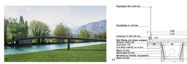
11-13 4. Preis: «Zenith» (Walt+Galmarini Bauingenieure, Zürich; LutzBuss Architekten, Zürich; Ganz Landschaftsarchitekten, Zürich). Äusserst schlanker dreifeldriger Durchlaufträger in Stahlbetonverbundbauweise. Längsschnitt, Mst. 1:600; Querschnitt im Scheitpunkt, Mst. 1:40 (alle Pläne+Visualisierungen: Projektverfasser)
