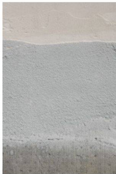
Körnigkeit und Eigenfarbe von Gipsputz
