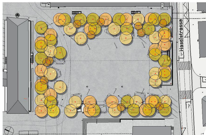
01+02 Zur Weiterbearbeitung: «Kelim» (Schmid Landschaftsarchitekten). Offener multifunktionaler Platz inmitten eines dichten Baumkranzes, ornamentale mäandrierende Entwässerungsbänder zieren die Fläche und runde Sitzmöbel laden zum Verweilen ein (Visualisierung + Pläne: Projektverfassende)
