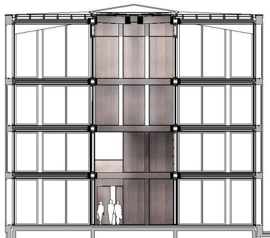
01+02 «Gio» (ARGE Imhof Nyffeler mit Joos & Mathys Architekten): Aussen Beton-, innen Holzskelettbau (Visualisierungen + Plan: Projektverfassende)
