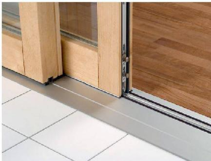
Das ebenerdige Schwellensystem der Alumat Rey GmbH, das auf einer DoppelmagNETTURDichtung basiert, kann bei Neu- und Umbauten für Aussentüren verwendet werden. Bei dem System ist die Ableitung von Regenwasser wichtig. Um zu verhindern, dass Feuchtigkeit in die Innenräume gelangt, wurde ein spezielles Ablaufsystem integriert. Eine verstellbare Silikon-Schleifdichtung im Wetterschenkel sorgt außerdem dafür, dass Schmutzablagerungen die Magnetfunktion nicht beeinträchtigen.
