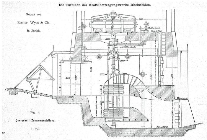
06 Querschnitt durch eine Turbinenkammer des Maschinenhauses mit Feinrechen und Drehtor (links), vertikalachsiger achtkränziger Francisturbine mit Generator (Mitte) sowie Wasserrückgabe in den Rhein (rechts) (Pläne: Energiedienst AG) 07 Grundriss der Grundablässe am rechtsufrigen Wehrende
