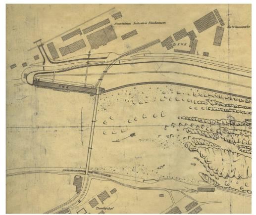
03 Maschinensaal nach Fertigstellung des Kraftwerks 1899 (Foto: Energiedienst AG) 04 Situationsplan des Rheinbetts im Abschnitt Gwild mit Maschinenhaus (links), Oberwasserkanal (oben) und Wehr (rechts) (Plan: Energiedienst AG) 05 Unterwasserseitige Ansicht des Maschinenhauses nach der Stilllegung der Anlage, Herbst 2010. Im Hintergrund rechts ist noch die Fachwerkbrücke über den Rhein erkennbar
