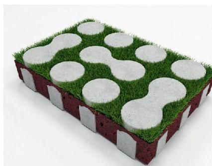
Sickerfähige Beläge leiten das Regenwasser ohne aufwendige Entwässerungs- und Retentionsmassnahmen direkt in den Boden und halten damit den natürlichen Kreislauf aufrecht. Sowohl Beläge, die das Wasser durch ihre poröse Struktur versickern lassen, wie auch solche, die das Wasser über die Fugen oder über Rasen-, Erd- oder Splittschichten ableiten, werden eingesetzt.
