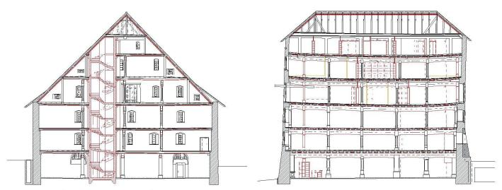
04-05 «Valjoux» (Edelmann Krell Architekten): Querschnitt und Längsschnitt, Mst. 1:400
