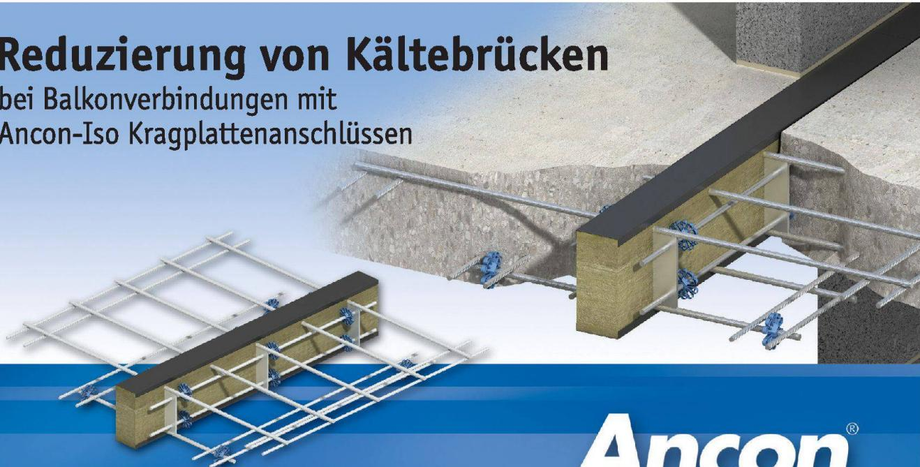
Ancon-Iso-Kragplattenanschlüsse bilden eine thermische Trennung zwischen auskragenden Balkonen und innenliegenden Betondecken zur Minimierung der Auswirkungen von Wärmebrücken.
