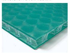
Neomat AG fertigt wetter- und lichtbeständige sowie schlagfeste Kunststoffe. Sie zeichnen sich durch eine vielfältige Optik und breite Einsatzmöglichkeiten aus. Mittels einer speziellen Klebetechnologie wird bei «Clear-Pep» ein bienenwabenähnlicher Kern mit transparenten, farbigen oder satinierten Deckschichten zu einem Paneel verbunden. Die Elemente sind in den Grössen 2.55×1.05 m und 3.02×1.22 m erhältlich.
