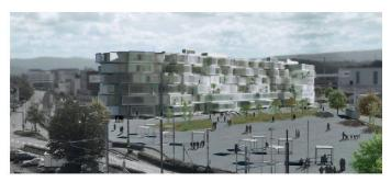
12 Skulpturales Containerlager: MVRDV nutzen das Lagerhaus als Regal für leichte Wohn- und Bürocontainer. Das Bild erzeugt einen hohen Wiedererkennungswert und vielfältige Aussen- und Zwischenräume. Allerdings führt das Konzept auch zu einer aufwendigen Verdreifachung der Konstruktion und erschwert das Einhalten des Minergie-P-Standards
