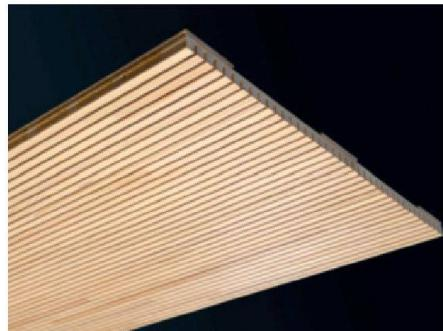
Die Akustikelemente aus der «Ligno Light»-Reihe von Holz-Baustoffe Schweiz haben eine fein geschlitzte, astreine Echtholz-Oberfläche, mit der Nachhallzeiten reduziert werden. Für die effektive Dämpfung des verbleibenden Geräuschpegels sorgen die Holzfaserabsorber, die hinter den Fugen der Decklage in die Elemente integriert sind. Die Elemente sind je nach Typ in den Dicken 62 und 33 mm erhältlich und in Längen zwischen 2400 bis 8000 mm. Ihre Verbindung erfolgt über Nut und Feder.
