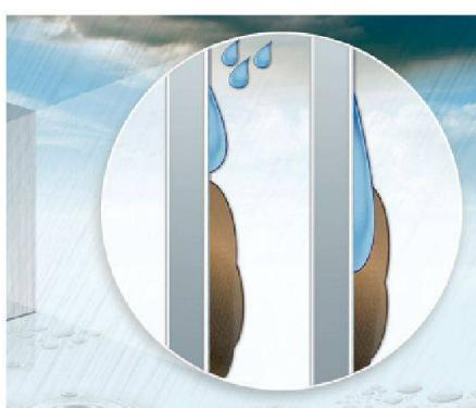
Alcoa Architectural Products bringt mit «Reynobond with EcoClean» eine Aluminium-Fassadenplatte auf den Markt, die mithilfe von Sonne und Feuchtigkeit sich selbst und die umgebende Luft von Schmutz- und Smogpartikeln reinigt. Die Titandioxid-Beschichtung «EcoClean» funktioniert wie ein Katalysator: An der Oberfläche bilden durch das UV-Licht frei gewordene Elektronen Radikale, die organische Substanzen wie Vogelkot, Moose, Abgase und Smogpartikel zersetzen.
