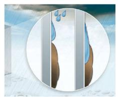
Alcoa Architectural Products bringt mit «Reynobond with EcoClean» eine Aluminium-Fassadenplatte auf den Markt, die mithilfe von Sonne und Feuchtigkeit sich selbst und die umgebende Luft von Schmutz- und Smogpartikeln reinigt. Die Titandioxid-Beschichtung «EcoClean» funktioniert wie ein Katalysator: An der Oberfläche bilden durch das UV-Licht frei gewordene Elektronen Radikale, die organische Substanzen wie Vogelkot, Moose, Abgase und Smogpartikel zersetzen. Alcoa Architectural Products
