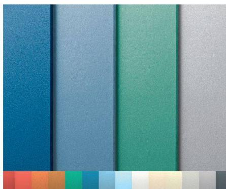
Fassadenplatten von Eternit sind in der Masse durchgefärbte, grossformatige Faserzementplatten mit einer einzigartig irisierenden Oberflächenveredelung. Die Verbindung des mineralischen Werkstoffs mit der schillernden Oberfläche verleiht dem Material eine überraschend eigenständige Intensität. Zur Wahl stehen 14 Farbtöne, verschiedene Fugen- und Befestigungslösungen sowie der beliebige Zuschnitt bis zum maximalen Format von 1220 x 3040 mm.
