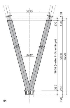
zontalkräfte auf und sorgt dafür, dass das Vordach nicht nach vorne wegkippt. Das Dach selbst ist als faltwerkartige Deckenscheibe konstruiert, und der filigrane Deckenrand nimmt die 14cm Stärke des Bandes der horizontalen Lufteinlässe der Gebäudefassade auf.
