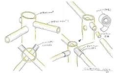
01–03 Das Raumteilersystem PPS4 ermöglicht ein Minimum an Privatsphäre in grossen Notunterkünften. Vier Module ( $2 \times 2 \text{m}$ ) bilden einen Raum mit  $16 \text{ m}^2$ : Stütze Kartonrohr  $\phi = 96 \text{ mm}$ , Balken Kartonrohr  $\phi = 56 \text{ mm}$ , Verbindung (eingeschoben) Kartonrohr  $\phi = 49.7 \text{ mm}$ , Vorhang aus wiederverwertetem Synthetikstoff (Foto: VAN, Skizze: Shigeru Ban)
