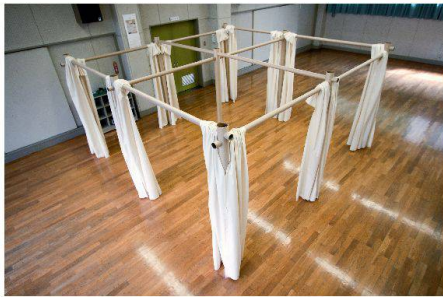
01–03 Das Raumteilersystem PPS4 ermöglicht ein Minimum an Privatsphäre in grossen Notunterkünften. Vier Module (2 x 2 m) bilden einen Raum mit 16 m 2 : Stütze Kartonrohr Ø=96 mm, Balken Kartonrohr Ø=56 mm, Verbindung (eingeschoben) Kartonrohr Ø=49.7 mm, Vorhang aus wiederverwertetem Synthetikstoff (Foto: VAN, Skizze: Shigeru Ban)
