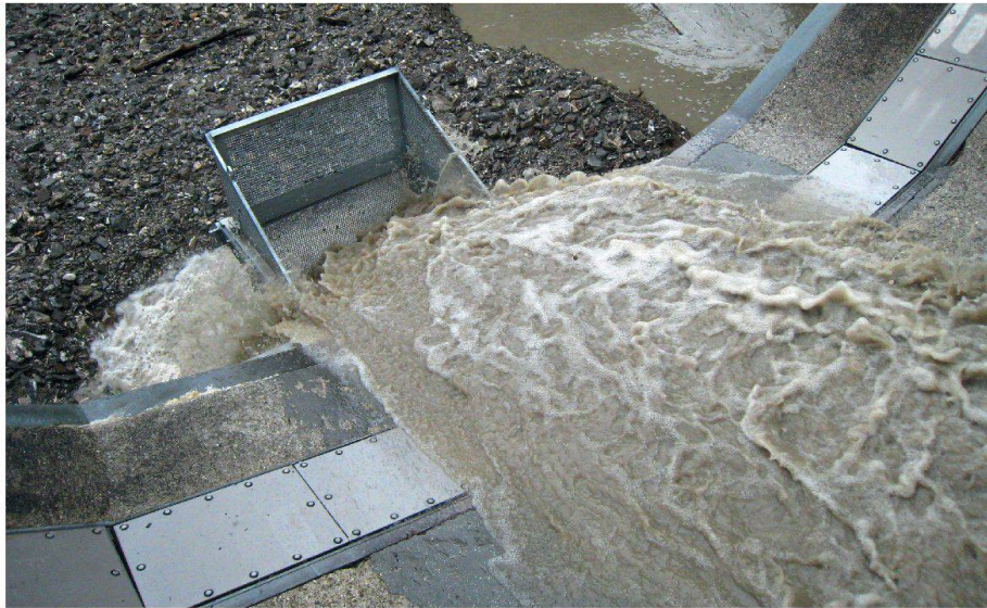
01 Gieschbefangkorb und Geophon-Sensoren zur Messung des Gieschbetransports im Erlenbach, Alptal SZ (Foto: WSL)
