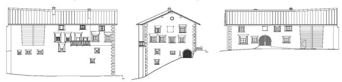
08 Ansicht Süd, Ost und Nord. Die starke Hanglage zum Inn hin führte zum Bau von zwei Untergeschossen, was den Sockelbereich aussergewöhnlich massiv wirken lässt. An den vergitterten Fenstern der Südfassade ist die Lage der Vorratskammer ablesbar. Das Tor an der Ostfassade führte zum im Untergeschoss gelegenen Stall, durch das Tor im EG (Nordfassade) wurde der Heustall erschlossen (Alle Pläne: Christoph Sauter Architekten)
