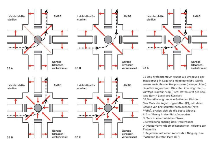
empfahlen. Die Wahl der Oberfläche der Platzebene fiel auf die Kegelform mit einer konstanten Neigung von 3% zum Platzrand hin, da diese für die Fahrdynamik, für die Oberflächenentwässerung und für den Bauablauf die beste Lösung bietet, nur geringe Anpassungen an die Umgebung fordert und eine Tramgeometrie gemäss den Anforderungen des Trambetreibers gewährleistet.
