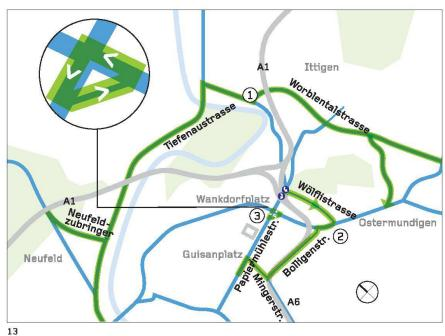
13 Das Grundkonzept der Verkehrsführung besteht aus der grossräumigen (1) und der lokalen Umfahrung (2) sowie der Kernumfahrung (3) (Plan: Team BE³, Egger Kommunikation)
