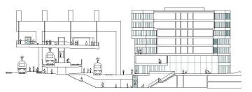
06+07 «True Grid»: Von einer mächtigen Tragstruktur (220m lang, 32m breit, 24m hoch) sind zwei Plätze neben der Hardbrücke abgehängt, die eine übersichtliche Erschliessung der Perrons mit langen Wegen ermöglichen. Zur Hardstrasse ensteht allerdings kein markanter Eingang (Bilder: Dürig)
