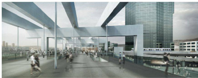
06+07 «True Grid»: Von einer mächtigen Tragstruktur (220m lang, 32m breit, 24m hoch) sind zwei Plätze neben der Hardbrücke abgehängt, die eine übersichtliche Erschliessung der Perrons mit langen Wegen ermöglichen. Zur Hardstrasse entsteht allerdings kein markanter Eingang (Bilder: Dürig)
