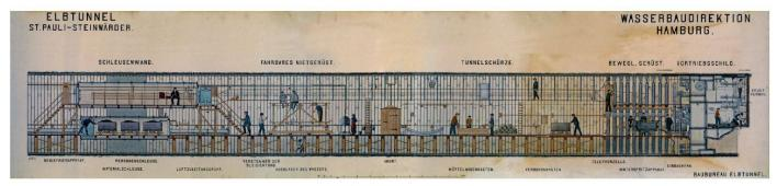
01 Darstellung der Vortriebsmethode für die Röhren des Elbtunnels (Bild: Hamburg Port Authority)
