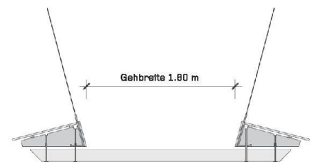
04 Um dem Wind möglichst wenig Angriffsfläche zu bieten, ist die Brücke windschlüpfriem geformt
