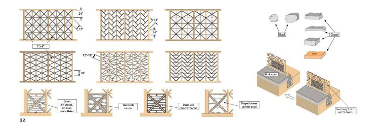
01 Erdbebenregion 🥽 in Kaschmir mit den Verbreitungsgebieten der traditionellen Bauweisen Bhatar und Dhajji (Plan: Tom Schacher) 02 Auszüge aus dem 40-seitigen Handbuch «Dhajji construction» für Bautechniker und Handwerker (Zeichnungen: Tom Schacher) 03 Musterhaus der Deza in Dhajji-Bauweise in Jared im Kaghan-Tal (Foto: Deza) 04 Ausfachung der Dhajji-Holzkonstruktion mit 3/4 Steinen und 1/4 Lehm oder Kalkmörtel (Foto: UN Habitat)
