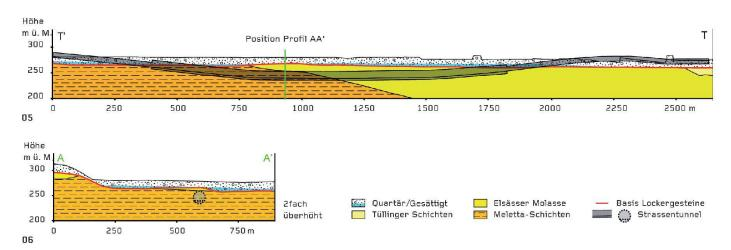
04 Lokales Teilmodell im Bereich der geplanten Tunneltrasse im Basler Süden. 3D-Ansicht mit Topografie (links), Basis der Lockergesteine und Grundwasserspiegel (Mitte) und Geologie der vom Tunnel durchfahrenen Schichten (rechts) 05 Geologisches Längsprofil (TT') der geplanten Tunneltrasse im Basler Süden 06 Geologisches Querprofil (AA', Lage vgl. Längsprofil in Abb. 5) der geplanten Tunneltrasse im Basler Süden
