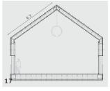
15–17 «Die Hütte am Gleisfeld»: öffentliches Haus über den Gleisen mit beidseitg verkleidetem Stahltragwerk (Fachwerk im oberen Bereich, Vierendeel im Bereich der Fenster). Die Montage erfolgt von beiden Seiten im Freivorbau mit Hilfsabstützungen. Die Zufahrten bzw. -gänge sind zu schmal für den vorgesehenen Mischverkehr. Das Deck bietet Aufenthaltsqualitäten, ist aber teuer in Erstellung und Unterhalt
