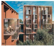
03-04 «E²volution»: Holzbausystem mit aussen liegenden vertikalen Schwertern und frei konfiaurierbaren Freisitzen (Bilder: Arup)
