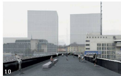
09–11 «Stadtbalkon»: Der 11 m breite Dreifeldträger (33.5 m, 78 m, 35 m) bildet eine attraktive Aussichtsterrasse. Allerdings sind die Treppen-/Rampenanlagen zu eng. Die reduzierte formale Gestaltung knüpft sehr eng an die Bahnarchitektur der 1960er-Jahre an und lässt den Steg selbstverständlich im urbanen Kontext aufgehen
