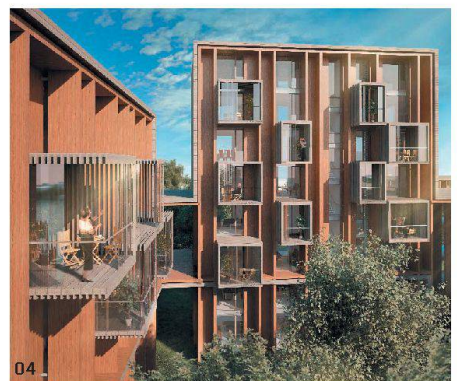
03–04 «E 2 volution»: Holzbausystem mit aussen liegenden vertikalen Schwertern und frei konfigurierbaren Freisitzen (Bilder: Arup)
