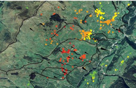
04 Hochauflösendes Satellitenradarbild einer tiefgründigen Rutschung im Aletschgebiet. Rote und violette Flächen zeigen Verschiebungen von einigen Zentimetern an, die grünen Flächen sind während dieser Aufnahmen vom Sommer 2008 stabil. Die Bewegungen haben sich als Folge des Rückzugs des Aletschgletschers verstärkt (Grafik: Bafu, SAR-Processing: Gamma RS,
