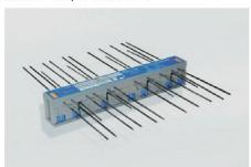
Schöck präsentiert ein neues Wärmedämmelement zur thermischen Trennung auskragender Bauteile bei Bestandsgebäuden. Planer können damit im Zuge einer Gebäudesanierung auf eine Produktlösung für den Anschluss von neuen Balkonen an vorhandene Stahlbetondecken zurückgreifen – sowohl bei frei auskragenden als auch gestützten Konstruktionen. Die verbesserte XT-Version der bewährten Isokorb-Reihe mit dem 120 mm dicken Dämmkörper aus Neopor wird ebenfalls vorgestellt.
