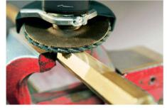
Würth stellt neue Vlies-Lamellenfächerschleifscheiben sowie ASSY-Schrauben in den Fokus. Die Schleifscheiben zur Bearbeitung von Stahl, Edelstahl, Aluminium und anderen Nichteisen-Metallen lassen sich dank dem robusten Trägerteller aus Glasgewebe direkt – also ohne zusätzlichen Stützteller – auf Winkelschleifern einsetzen. Weitere Produkte: Dübeltechnik, neuste Li-Ion-Akku-Maschinen, MODYF-Arbeitskleidung und Sicherheitsschuhe sowie ORSY-Lagermanagement.
