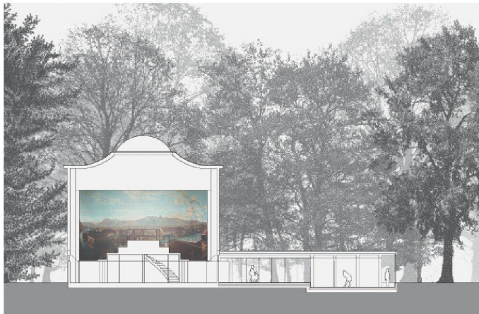
03+04 «Hiroba»: Das Dach der pavillonartigen Erweiterung nimmt die Sockelhöhe der Rotunde auf und liegt auf dem quadratischen Nebenraumkern auf
