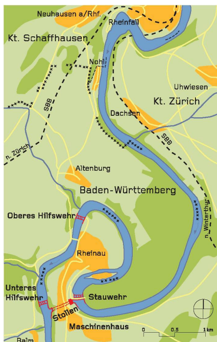
01 Gemäss einer Studie des Rheinaubundes müsste die Restwassermenge in der Rheinschleife je nach Jahreszeit auf 90 bis 130 m 3 /s erhöht werden, um den ökologischen Zustand zu verbessern (Plan: Kraftwerk Rheinau/Red.)
