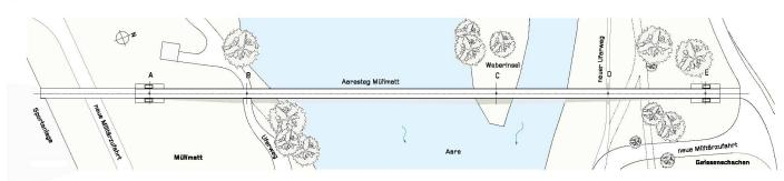
02 Die mehrfeldrige Spannbandbrücke in vorgespanntem Beton über die Aare verbindet Brugg und Windisch direkt neben dem neu gebauten Sportausbildungszentrum Mülimatt
