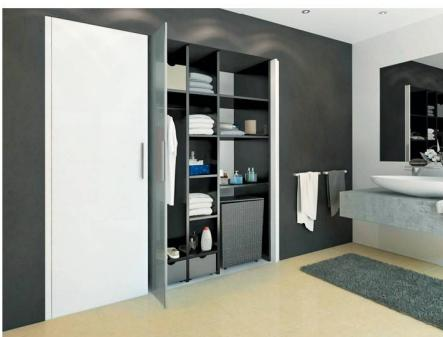
«HAWA-Concepta» ist ein System für Holz- und Glastüren, das auf eine Bodenführung verzichtet und eine flexible Raumnutzung ermöglicht. Auch in Sachen Abmessungen ist es flexibel einsetzbar: Türhöhen bis 2850mm, Breiten zwischen 300 und 900mm, Holzdielen 19 bis 50mm, bei Glas (Einscheibensicherheitsglas) 8mm. Gleichzeitig erhält man im Schrank einen grösstmöglichen Stauraum, weil zum Beispiel eine bis zu 30mm dicke Tür nur eine maximale Nischenbreite von 55mm benötigt.
