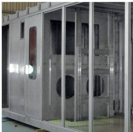
Die Funktionscontainer von Elkuch Eisenring ersetzen Räume in immissionsreichen Umgebungen, also bei starkem Lärm, hoher Verschmutzung oder bei Extremtemperaturen. Statt eines aufwendigen Innenausbaus lassen sie sich in «unwirtliche» Produktionsumgebungen integrieren und sorgen für zuverlässig ausgeführte Prozesse. Als Gebäudeersatz wird ein Container dann ver-
